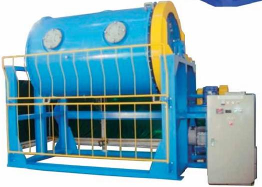
バッチボールミル (水冷式ウォータージャケットタイプ)
