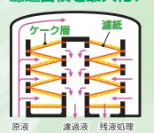
濾材 (濾紙や濾布) を両面に挟み 込む事で複面濾過機構を実現し、 処理濾過量を増大させました。
