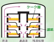
濾枠の高さ調節と片面濾過により、 ケーク量の多い液体の濾過でも、ス ムーズな継続使用が可能です。
