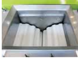
アルミナセラミック波歯口ロール Alumina Ceramic Wave Shaped Roll
