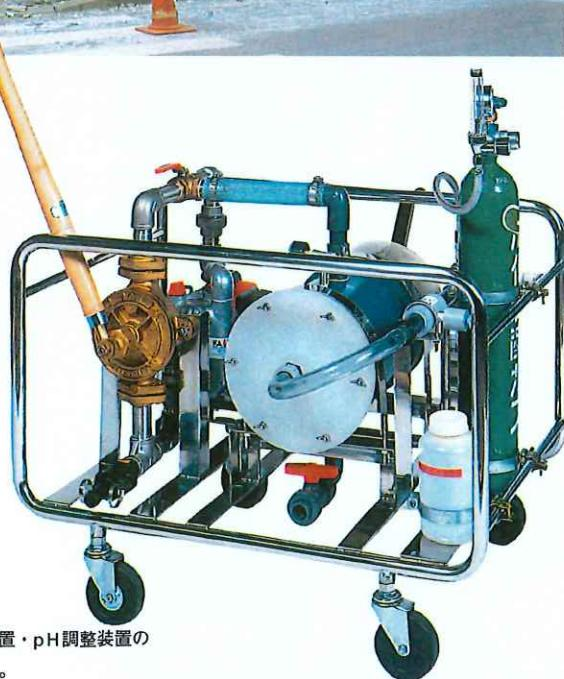
※写真は塩素注入装置・pH調整装置のオプション付です。
